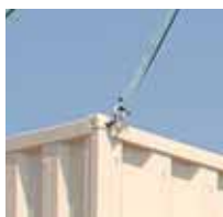
crochets pour fixation d'élingue
